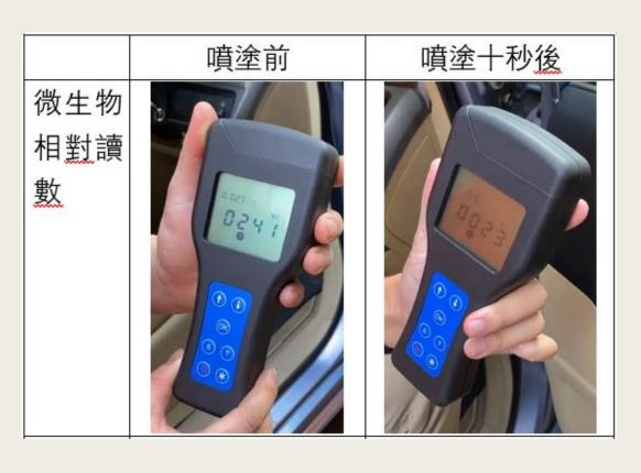
在汽車內噴塗燈觸媒之前與之後的細菌含量測試。
